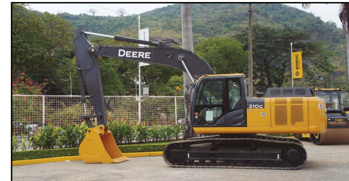
Excavadora John Deere 210GLC Potencia NETA: 159 Hp Peso: 22.4 tons Cucharón: 1,2 m3 Brazo: con 3 refuerzos – Heavy Duty
