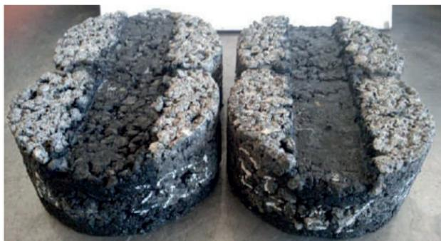
Mediante estudio de ruido (ver figura 2), se determinó que un tramo con incorporación de polvo de caucho reciclado por vía húmeda presenta en promedio, una reducción de 3 a 5 decibeles respecto a una mezcla convencional, esto además por sus propiedades absorbentes a las que fueron diseñados.
