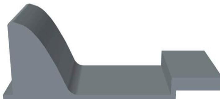
**Figura 3. Modelo en 3D del Vertedero Creager y colchón de aguas (AutoCAD-DWG)**
